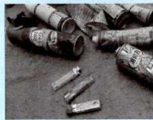
ライターやスプレー缶が清掃車から発見されました。今回の出火原因はライターでした。※清掃車両でプレスされた際に出火します。
