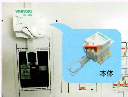
地震の際、バネの強い力により確実にブレーカーを遮断。地震による停電からの復帰時、通電火災を防止します。高さ・長さの調節ができ、レバー埋込型・扉付きタイプのブレーカーにも取付
