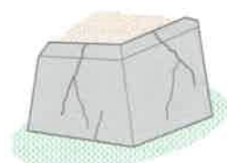
ひび割れの発生
