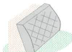
擁壁のふくらみ
